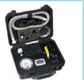
Das **Interceptor® Plus Druckprüfset** umfasst alles, was Sie zur Durchführung regelmäßiger Tests brauchen, einschließlich Anschlussschläuche und Ventile, Luftgebläse und Magnahelic®-Manometer. Verwenden Sie es als Teil des Systems für regelmäßige Wartung, um sicherzustellen, dass Ihr Interceptor® Plus Anzug immer gasdicht bleibt. Separat erhältlich.
