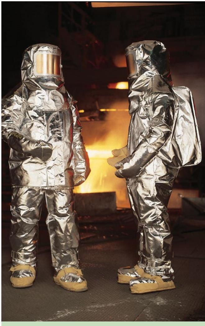
Traje aluminizado de triple capa con barrera antihumedad y barrera térmica adicional de fibra de vidrio para una protección térmica superior
