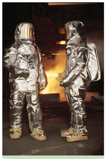
Aluminisierter dreischichtiger Anzug mit Feuchtigkeitssperre und zusätzlicher Wärmedämmschicht aus Glasfaser für überlegenen Hitzeschutz
